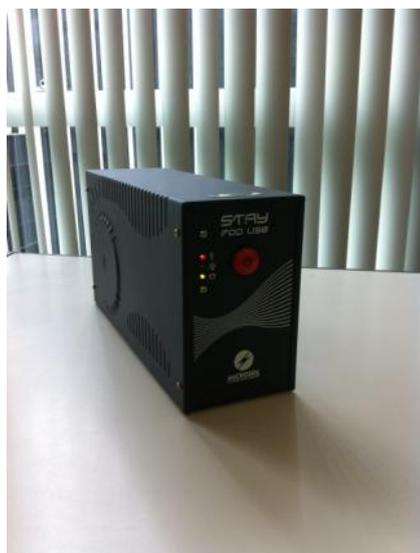
*O no-break Stay 700 possui leds informativos da utilização do equipamento (mostrador frontal), informando conexão na rede elétrica e utilização da carga da bateria. Além do mostrador visual, o equipamento emite sons quando o equipamento entra em funcionamento, na modalidade de carga da bateria. Na medida que a carga esteja chegando ao fim, os bips são intensificados, demonstrando a urgência em desligar o micro (salvando os arquivos em utilização).*
