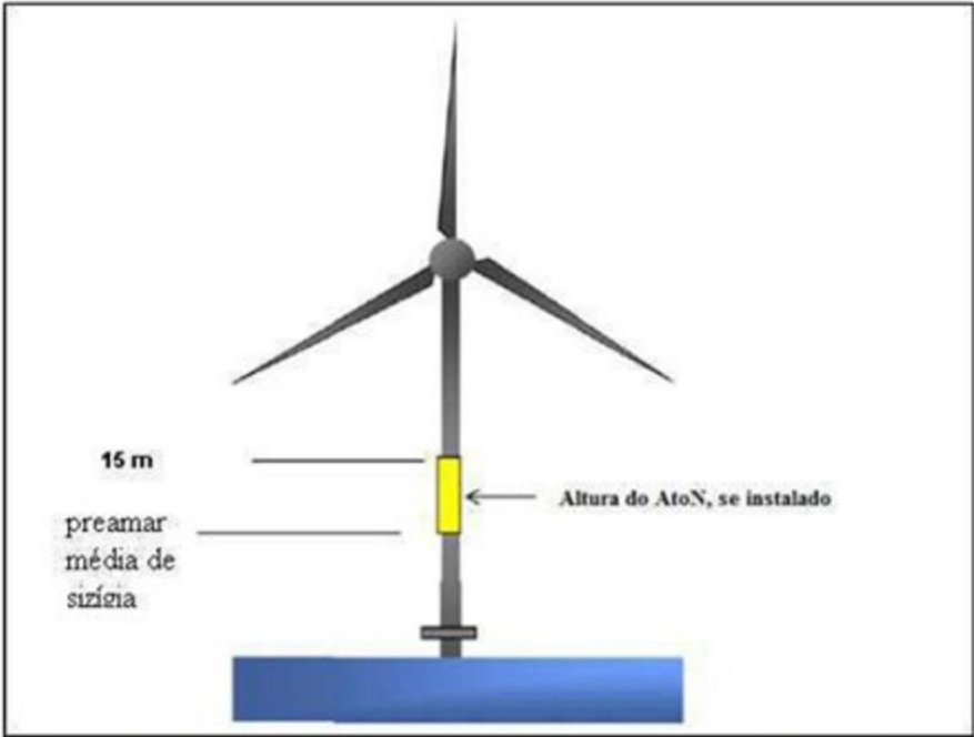
Sinalização de Estruturas Offshore. Fonte: Modificado da Recomendação da IALA O-139, "The Marking of Man-made Offshore Structures".
